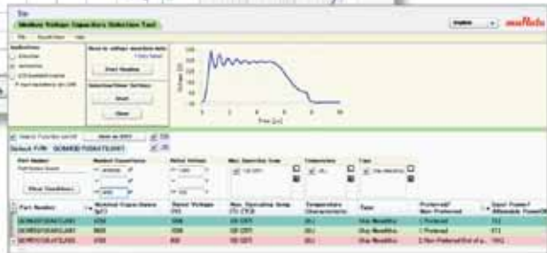
新增了电容器检索工具，以查找适用于指定电压波形的高中高压电容器。
